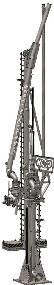
Автоматизированный стендер КОЗ СР-250, оснащенный системой аварийного разъединения (САР) и приводной муфтой аварийного разъединения (ПМАР)
