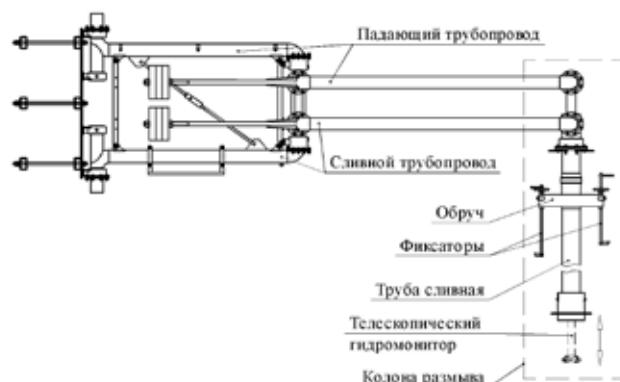
Устройство предназначено для работы в комплекте с внешним насосным и теплообменным оборудованием.
